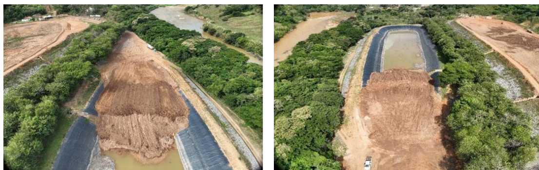
Figura 4 - Disposição de sedimentos bacia 1
