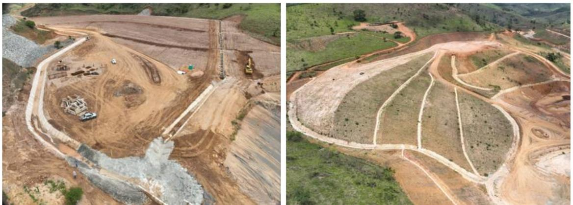
*Figura 6 - Sistema de drenagem contrapilamento OE / Sistema de drenagem Pilha 01 e ADME-1*
