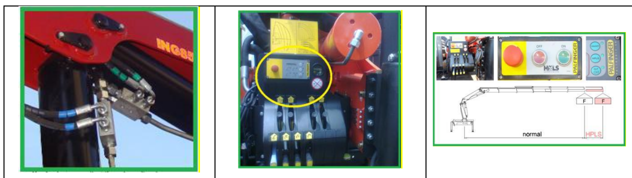
Válvulas de retenção e segurança ou limitador hidráulico de momento de carga: Requisito obrigatório para Guindauto
