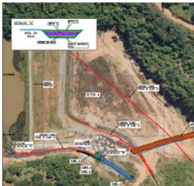
Figura 16 - Melhoria realizada: sistema de controle na entrada do efluente (pedras em transição e geotêxtil) e na saída do efluente (sump e sistema filtrante: enrocamento, britas em transição e geotêxtil)
