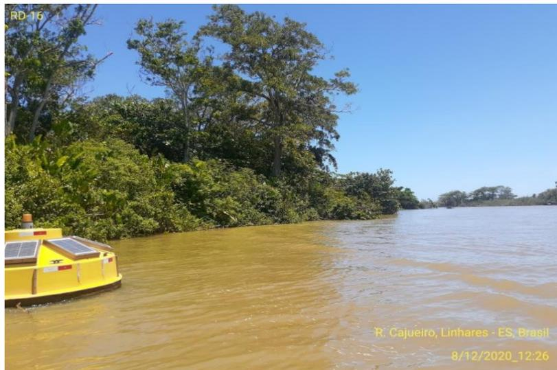
**Observação:** Ausência de resultados do dia 07/12/2020 até o dia 08/12/2020 às 15:00h, pois foi identificado pela equipe de campo um curto no controlador de carga e fusível. Foi realizado a substituição do controlador de carga e fusível e os dados voltaram a ser transmitidos normalmente às 16:00h do dia 08/12/2020.
