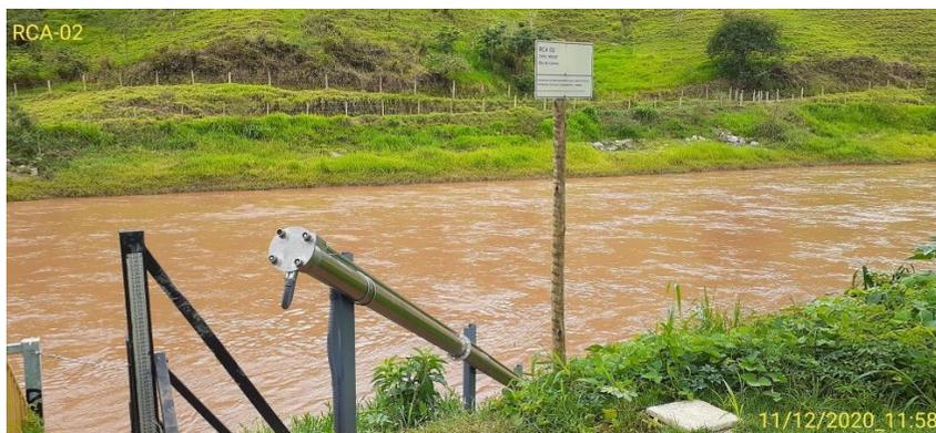
**Observação:** Foi identificado pela equipe de campo que a partir do dia 05/12/2020 às 16:00h ocorreu falha de dados de nível devido um defeito no sensor de nível após incidências de chuva e possivelmente descarga atmosférica. Foi realizado a substituição do sensor e os dados voltaram a ser transmitidos normalmente a partir das 11:00h do dia 11/12/2020.
