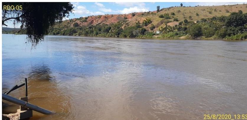
**Observação:** Os resultados observados nos gráficos de condutividade e turbidez do dia 03/08 até o dia 04/08 às 08:00h, são inconsistentes, pois foi identificado pela equipe de campo que a sonda encontrava-se somente com a ponteira dos sensores submersos na água e não ela por inteira, impactando na correta leitura. Realizado ajuste de Offset do nível em mais 13 cm, devido a discrepância encontrada entre o valor indicado na régua limimétrica e o valor indicado na PCD no dia 25/08/20.
