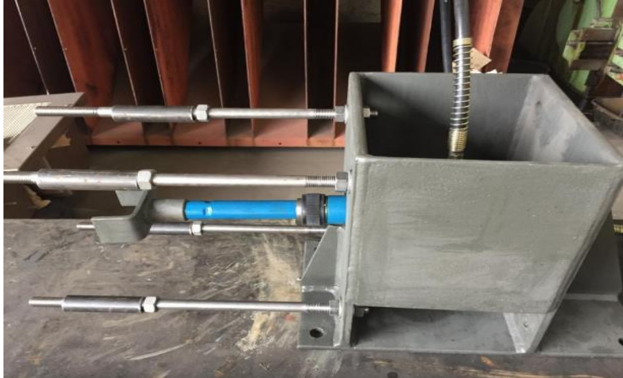
Foto relacionada ao: Novo dispositivo para abertura do flange da escotilha na Unidade Geradora 2 - Maio/19.
