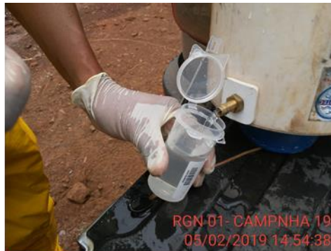
Coleta no ponto RGN 01 (frasco para avaliação do parâmetro Escherichia coli ) Crédito: Fundação Renova
