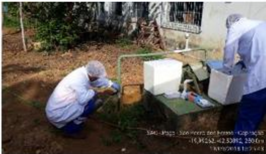
Coleta de água realizada em captação subterrânea para atendimento ao Programa de Monitoramento de Água para Consumo Humano na Escola do Lajão, em São Pedro dos Ferros/MG
