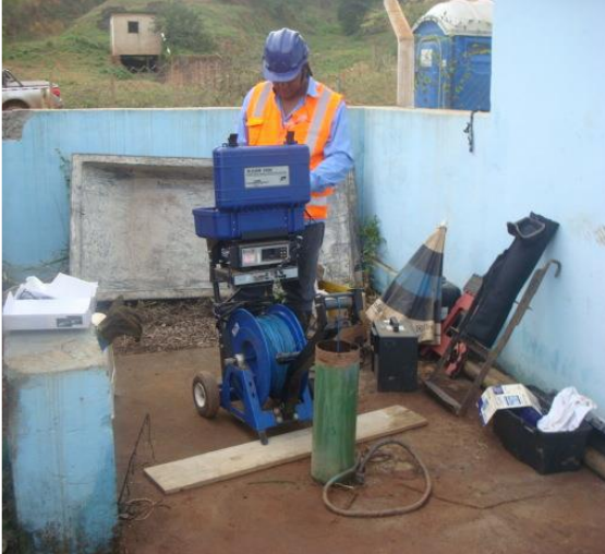
Perfilagem do poço em Barra Longa – Gesteira – Junho/2018 (Crédito: Divulgação Fundação Renova)
