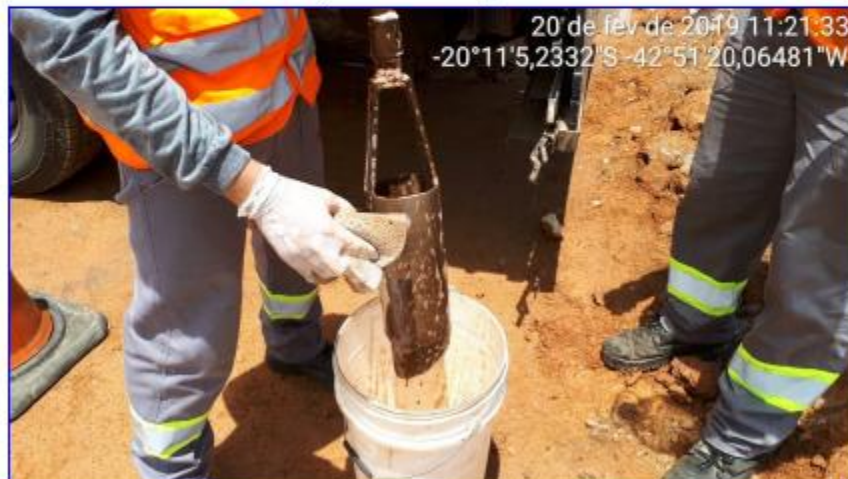
Higienização do trado manual a cada mudança de ponto de sondagem
