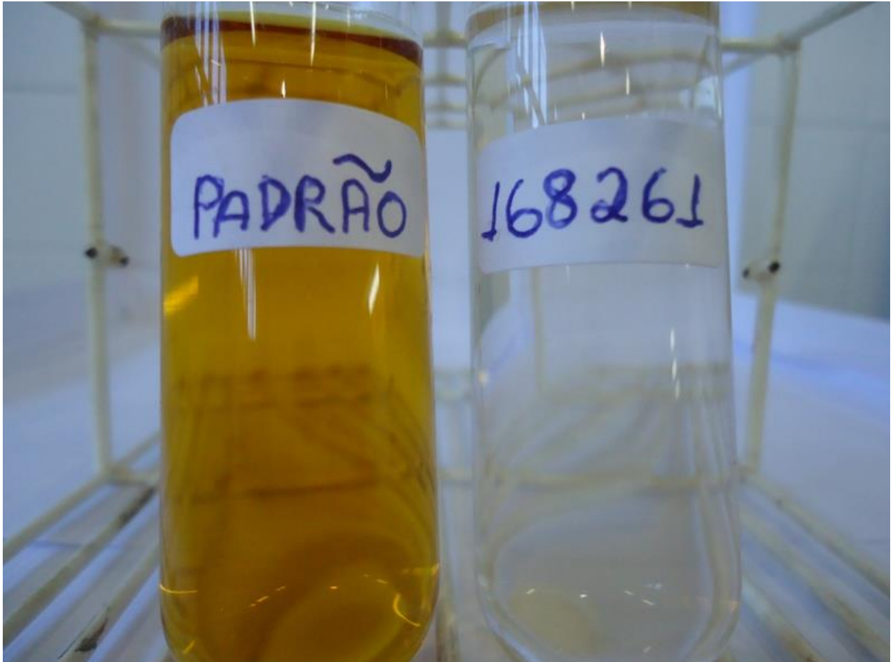
Foto 1 - Ensaio comparativo de impurezas orgânicas. A amostra de rejeito de mineração apresentou solução mais clara que a solução padrão, indicando ausência de impurezas orgânicas no material.
