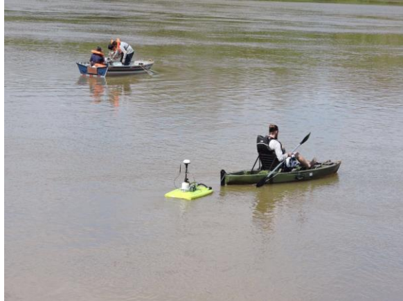
Medição de descarga líquida e coleta manual em ponto de monitoramento do rio Doce em Governador Valadares (MG) (código RDO07) – agosto/2017 (Crédito: Divulgação Fundação Renova)
