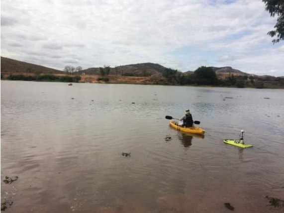
Medição de descarga líquida em ponto de monitoramento do rio Doce em Periquito (MG) (código RDO06) – agosto/2017 (Crédito: Divulgação Fundação Renova)
