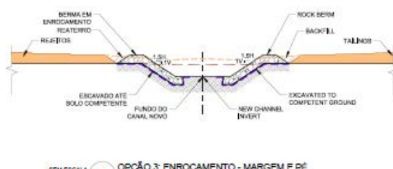
Figura 49: Opções típicas de bioengenharia – Opções 1 a 6.
