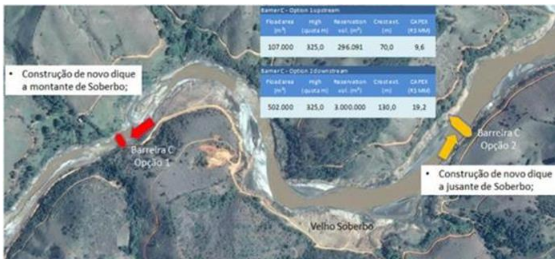
Figura 27: Estudos locais para barramento C.
