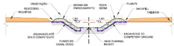
SEM ESCALA 4 **OPÇÃO 4: ENROCAMENTO E VEGETAÇÃO - MARGEM E PÉ**
