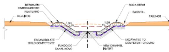
SEM ESCALA 3 **OPÇÃO 3: ENROCAMENTO - MARGEM E PÉ**
