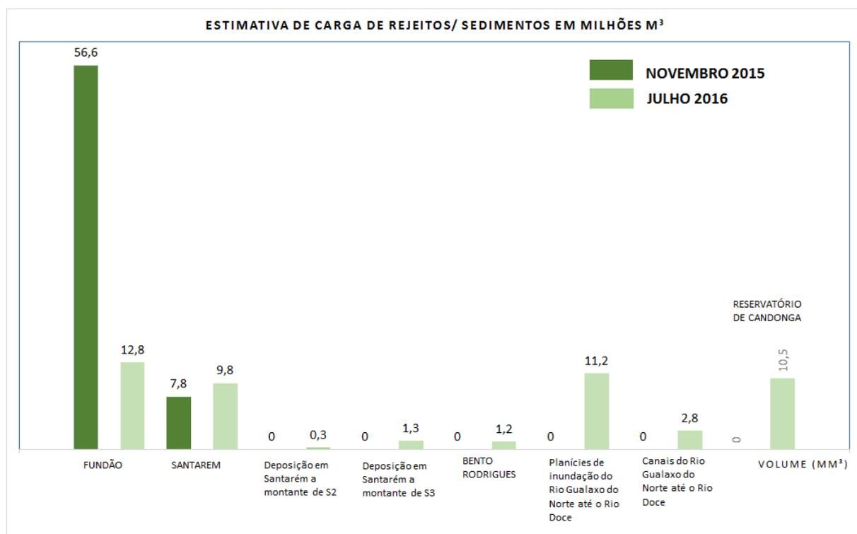
Figura 7: Estimativa de Carga de Rejeitos / Sedimentos em milhões m<sup>3</sup> (Fonte: Golder, RT-023\_159-515-2282, Anexo Seção 5.0).
