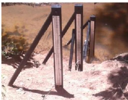
Figura 18: Seção linimétrica e sensor de nível automático
