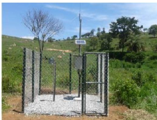
Figura 17: Estação pluviográfica e data logger
