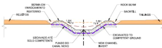
SEM ESCALA 2 **OPÇÃO 2: ENROCAMENTO - MARGEM E COLCHÃO**
