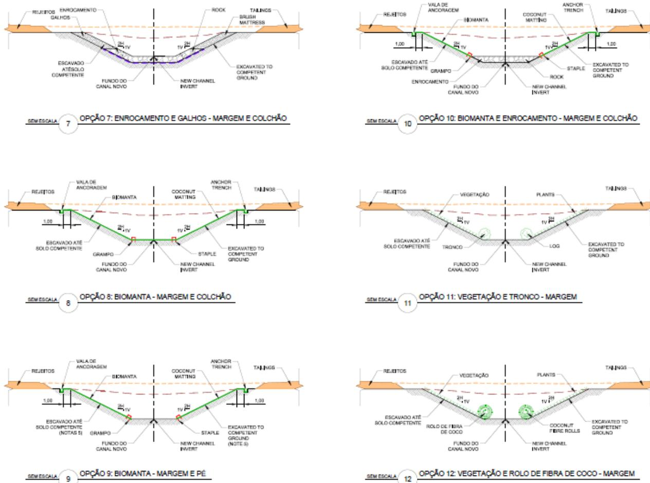
Figura 20: Opções típicas de bioengenharia – Opções 7 a 12 (Golder Associates - G006900-C-100025\_R-01, ver Anexo Seção 7.3).
