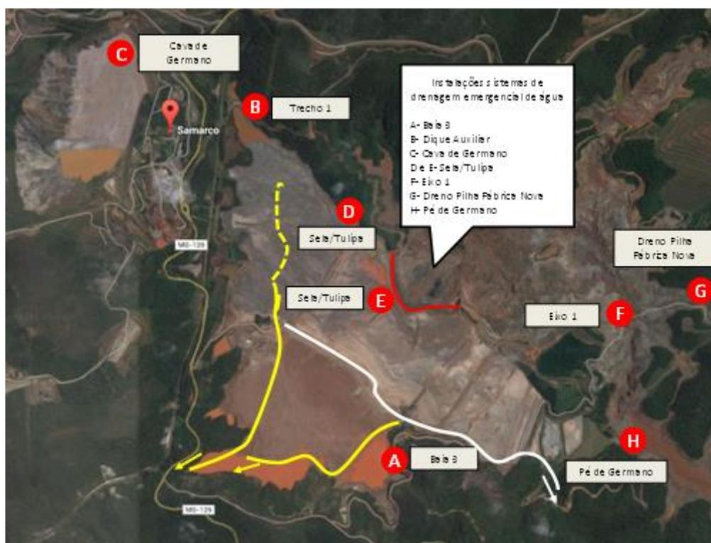
Figura 9: Localização dos bombeamentos implantados – Pontos vermelhos.
