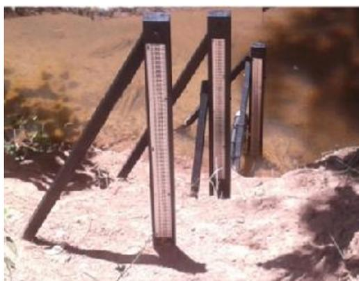
Figura 19: Seção linimétrica e sensor de nível automático
