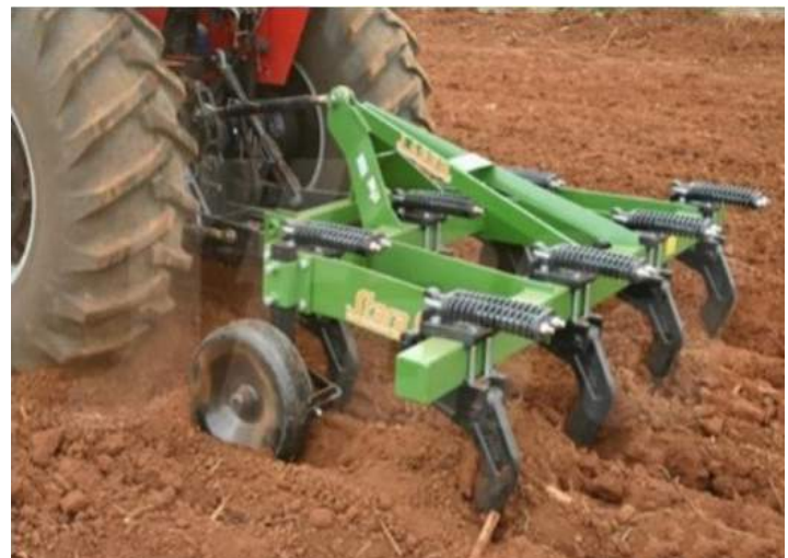
Figura 20 Subsolador com sete hastes
