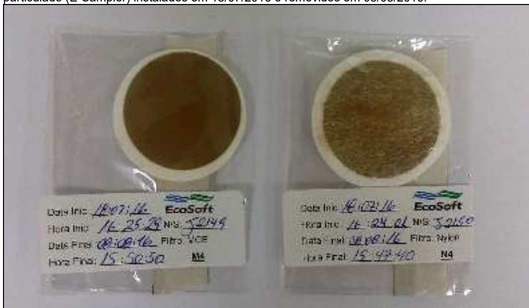
Fotografia 5.1 - Filtros de amostragem Nylon (N4) e MCE (M4) dos analisadores de material particulado (E-Sampler) instalados em 18/07/2016 e removidos em 08/08/2016.
