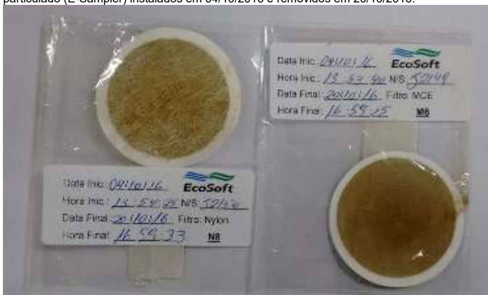
Fotografia 5.2 - Filtros de amostragem Nylon (N9) e MCE (M9) dos analisadores de material particulado (E-Sampler) instalados em 20/10/2016 e removidos em 17/11/2016.
