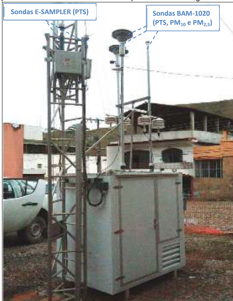
Fotografia 2.1 - Sondas de amostragem dos analisadores de material particulado instalados no container compacto em Barra Longa-MG
