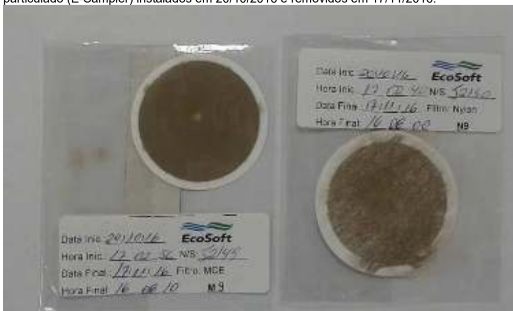
Fotografia 5.2 - Filtros de amostragem Nylon (N9) e MCE (M9) dos analisadores de material particulado (E-Sampler) instalados em 20/10/2016 e removidos em 17/11/2016.
