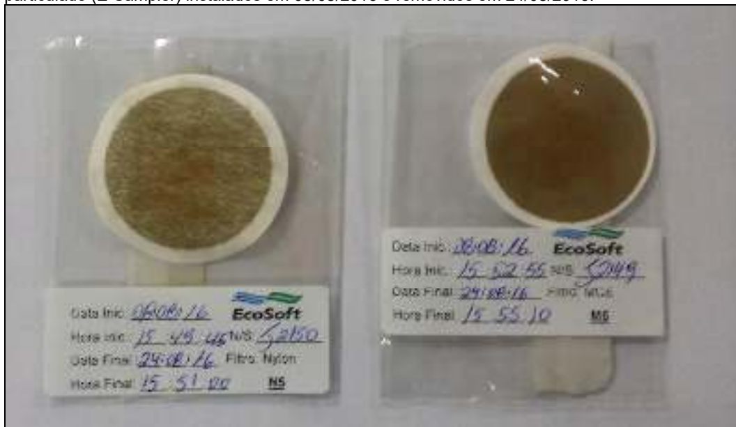
Fotografia 5.2 - Filtros de amostragem Nylon (N5) e MCE (M5) dos analisadores de material particulado (E-Sampler) instalados em 08/08/2016 e removidos em 24/08/2016.
