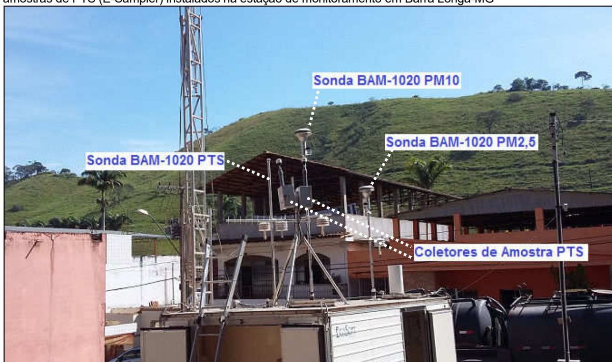
Fotografia 2.1 - Sondas de amostragem dos analisadores de material particulado (BAM-1020) e coletores de amostras de PTS (E-Sampler) instalados na estação de monitoramento em Barra Longa-MG
