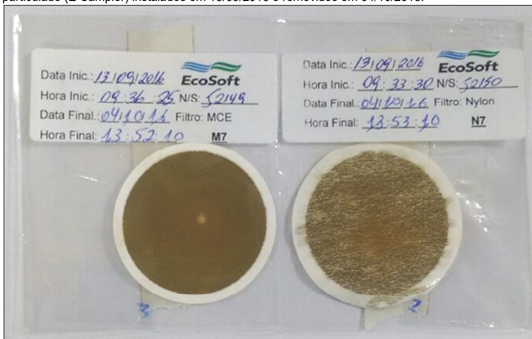
Fotografia 5.1 - Filtros de amostragem Nylon (N7) e MCE (M7) dos analisadores de material particulado (E-Sampler) instalados em 13/09/2016 e removidos em 04/10/2016.
