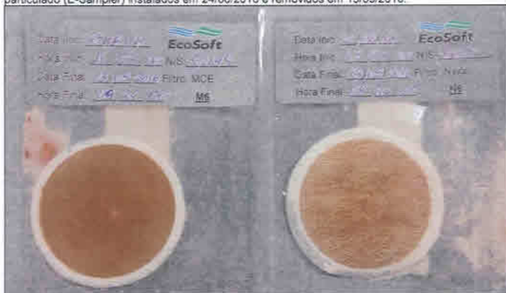
Fotografia 5.1 - Filtros de amostragem Nylon (N6) e MCE (M6) dos analisadores de material particulado (E-Sampler) instalados em 24/08/2016 e removidos em 13/09/2016.
