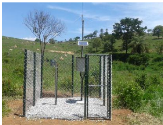
Figura 2.1 – (a) Estação pluviográfica e data logger
