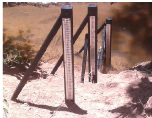
(b) Seção linimétrica e sensor de nível automático
