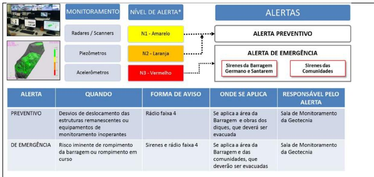
Figura 55: Estrutura do sistema de monitoramento e alerta de emergências em barragens.
