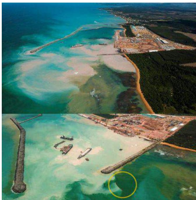
Figura 52 - Operação de dragagem sem a presença da cortina de antiturbidez (acima) e efeitos de sua atuação (abaixo, em destaque). (GTECAD 2016)
